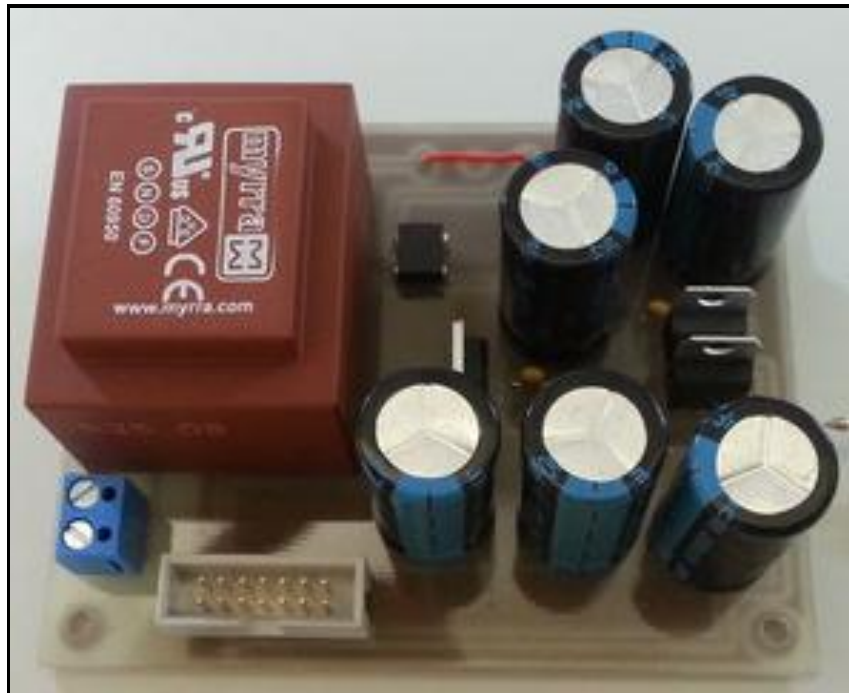
Abbildung 16: Netzteilplatine, (Eigene Darstellung)
