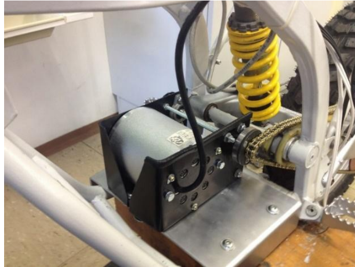
Abbildung 4: Motorhalterung aus Stahlblech
