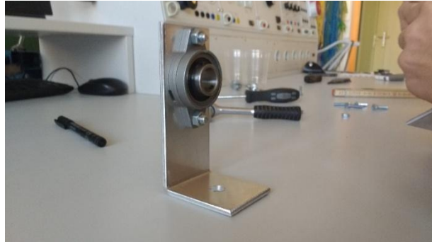
Abbildung 9: Flanschlager mit Halterung
