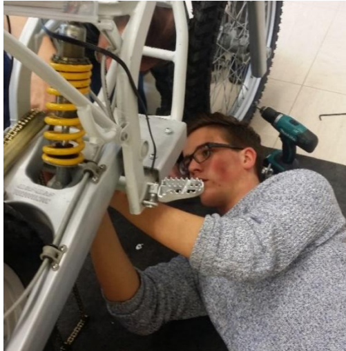
Abbildung 11: Demontage der Grundplatte
