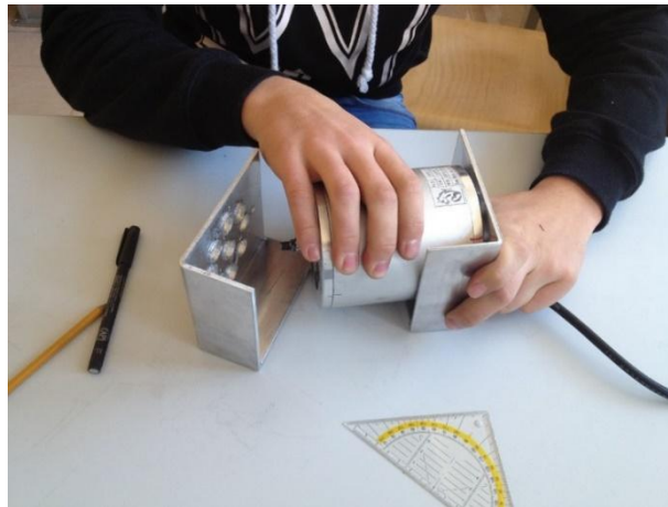
Abbildung 8: Bohrungen an der Motorhalterung
