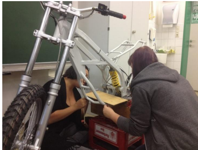
Abbildung 2: Schablone für die Grundplatte
