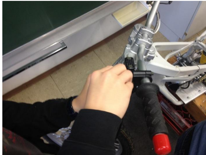
Abbildung 3: Anschluss der Bremsschalter
