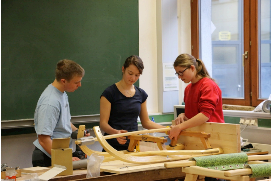
Abbildung 10: Zusammenbau des Sportrodels (Eigene Darstellung)
