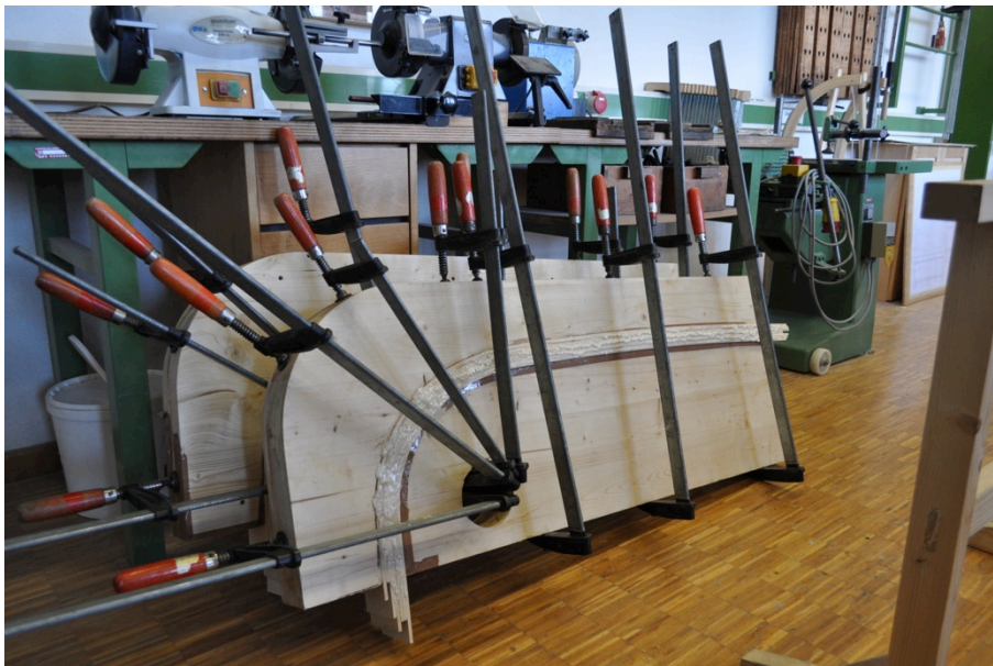
Abbildung 4: Verleimte Kufen (Eigene Darstellung)
